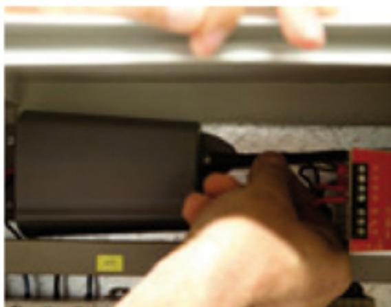
Desenroscar el cable de la antena.
